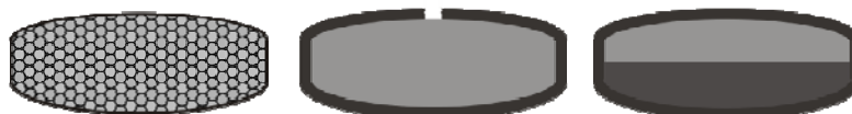
Rysunek 3.5. Od lewej, tabletka z lekiem w matrycy polimerowej, tabletka z lekiem w otoczce półprzepuszczalnej z dyszą, tabletka w otoczce półprzepuszczalnej z osmotycznym czynnikiem napędowym.
